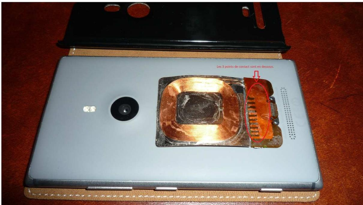
4/ Ça colle un peu aux doigts... Fixer le tout avec du scotch en laissant le côté sans bouton 'libre'. Cela permettra d'enlever la coque sans tout arracher, car une fois en place, la partie adhésive va se fixer (pas de façon irréversible)
