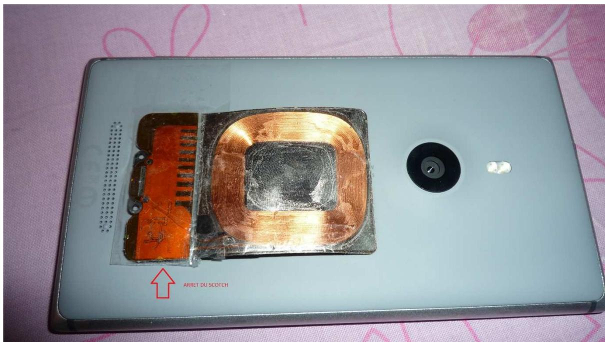
5/ Poser le téléphone sur la vitre, bien à plat (planche à repasser par exemple). Approcher la nouvelle coque en insérant en premier le côté aux boutons. Une fois les boutons en place rabattre la coque sur le téléphone.
